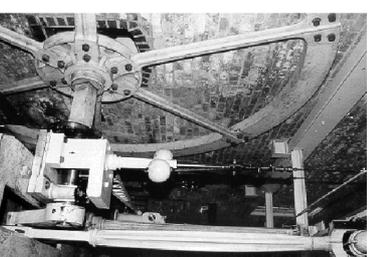
La fotografía muestra un regulador centrífugo de Watt usado en una máquina de vapor en una fábrica de telas cerca de Manchester, en el Reino Unido. Manchester fue el centro de la revolución industrial. La fábrica de telas está aún en operación.
