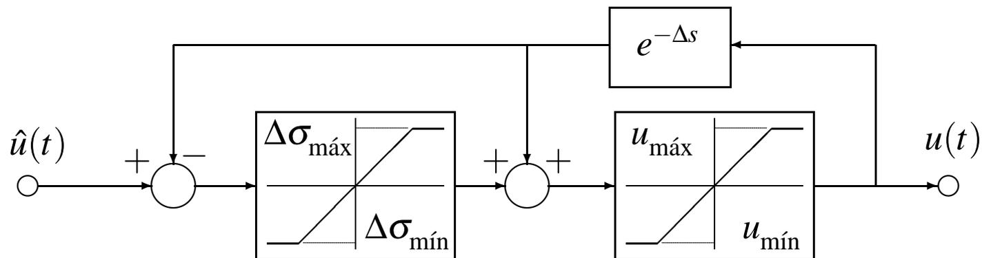
Figura 8: Modelo de limitador combinado saturación-*slew rate*
