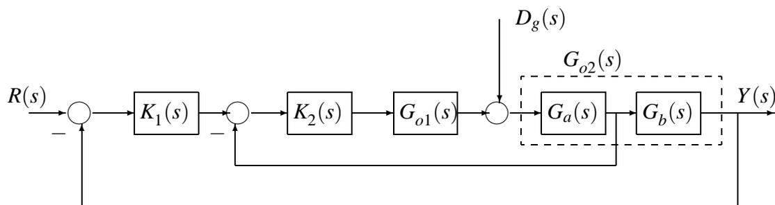
Figura 2: Esquema de control en cascada
