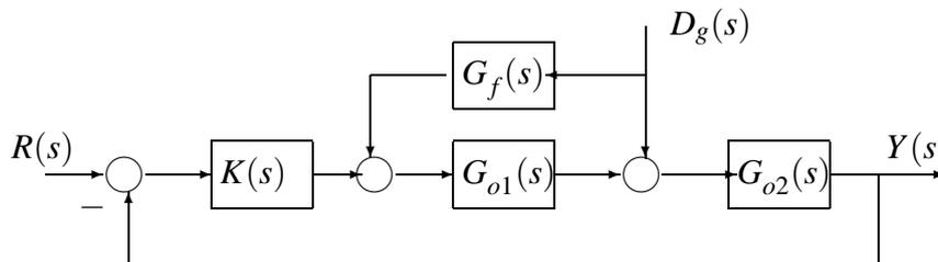
Figura 1: Esquema de inyección de perturbación
