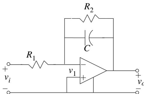
Figura 4: Circuito con amplificador operacional
