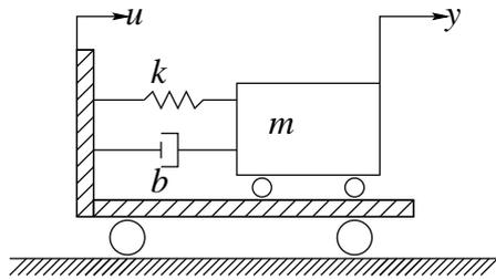
Figura 1: Sistema masa-resorte-amortiguador en un carro
