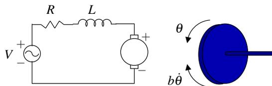
Figura 7: Motor de CC, circuito de armadura y rotor
