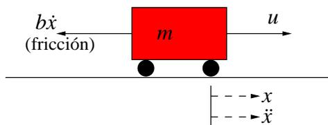
Figura 5: Sistema simplificado del control de velocidad crucero
