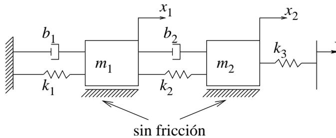
Figura 2: Sistema mecánico con una entrada y dos salidas
