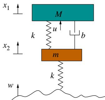
Figura 6: Sistema de suspensión de un autobús
