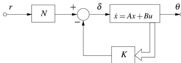
Figura 3: Esquema de realimentación de estados
