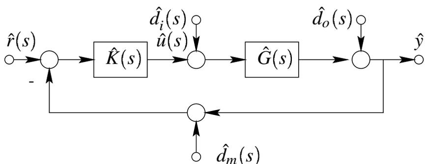
Figura 1: Estructura de control de un grado de libertad.
