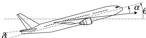
Figura 2: Control de ángulo de elevación
